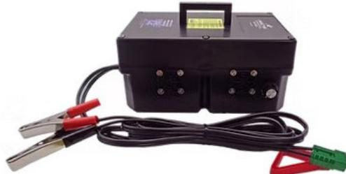
Régulation constante de la tension (augmente la sortie de tension de la batterie de 12 V à 24 V constants). Permet de réguler le débit des pompes 12 Volts mais ne convient pas pour l'échantillonnage à faible débit (low flow). Inclut une protection contre l'inversion de polarité et une protection thermique.Pour les pompes MONSOON et HURRICANE.
